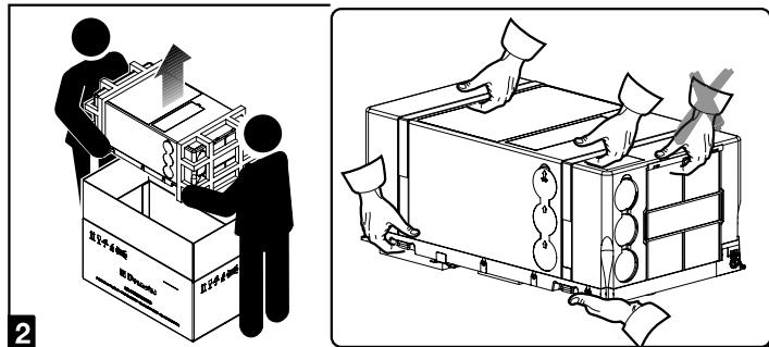
Lyft maskinen och kontrollera att den är i gott skick.
