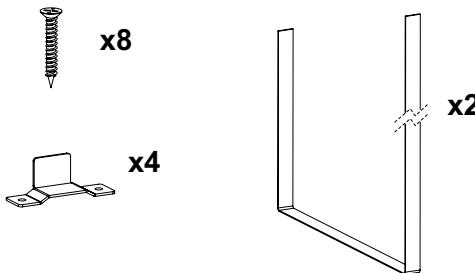
Med metod 3 används 4 skruvar och 4 brickor för fixering av maskinen.
