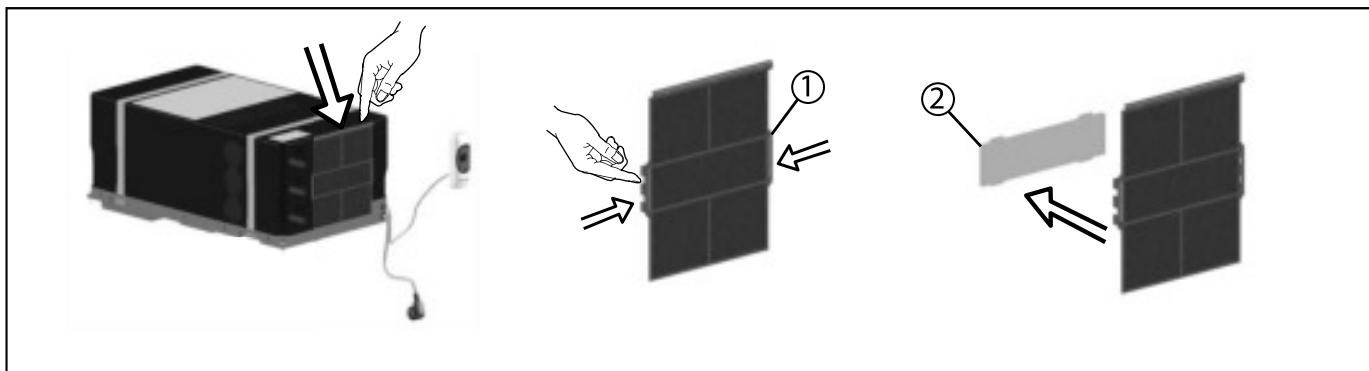
**Rengöring av filter (1):** Rengör filtren (N.1) regelbundet och tvätta dem i en lösning med rengöringsmedel. Låt filtren torkan innan de sätts tillbaka.
